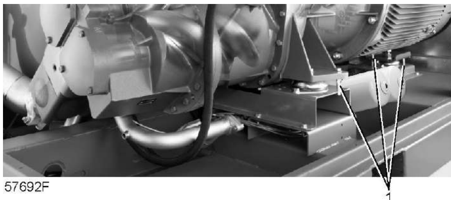
Транспортировочные крепления компрессоров GA VSD
